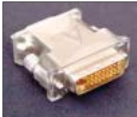
◀ Mittels Adapter passt auch jeder gängige RGB-Stecker an die VTBook-Karte
