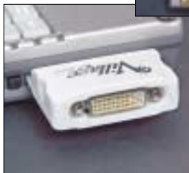
◀ Eingesteckt in den PC-Card-Schacht schaut die Grafikkarte nur rund 35 Millimeter aus dem Notebook heraus
