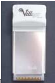
◀ Eingesteckt in den PC-Card-Schacht schaut die Grafikkarte nur rund 35 Millimeter aus dem Notebook heraus
