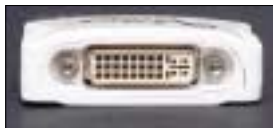
◀ Die PC-Card selbst verfügt über eine DVI-Schnittstelle
